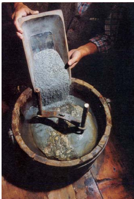
Tav. 43 Il minerale viene caricato nel molinetto e finemente macinato; il movimento del molinetto è determinato dal flusso di acqua sulle pale della ruota. (R. Cerri, A. Zanni, 2008: 358)
