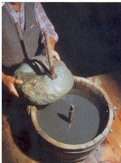
Tav. 44 Si aggiunge il mercurio ("argento vivo"); seguono alcune ore di macinazione per consentire l'amalgamazione con l'oro. Dopo la macinazione la moletta viene tolta dal molinello. (R. Cerri, A. Zanni, 2008: 359-360)
