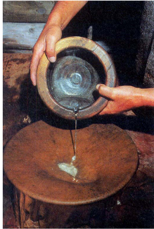
Tav. 47 Il mercurio con l'oro viene versato nella pelle di camoscio bagnata aderente ad un largo piatto di legno. (R. Cerri, A. Zanni, 2008: 363)
