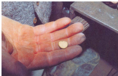
Tav. 52 Il bottone d'oro al termine della fusione ("oro rosso"). Esso si saggia con l'acido nitrico per stabilirne la qualità. (R. Cerri, A. Zanni, 2008: 366)
