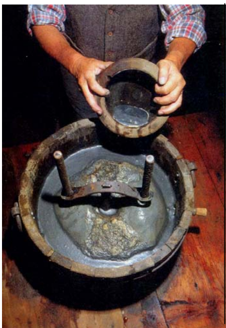
Tav. 44 Si aggiunge il mercurio ("argento vivo"); seguono alcune ore di macinazione per consentire l'amalgamazione con l'oro. Dopo la macinazione la moletta viene tolta dal molinello. (R. Cerri, A. Zanni, 2008: 359-360)
