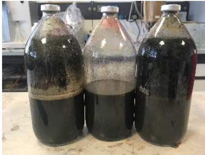
Fig. 6.1: le bottiglie contenenti i campioni per le analisi BMP
