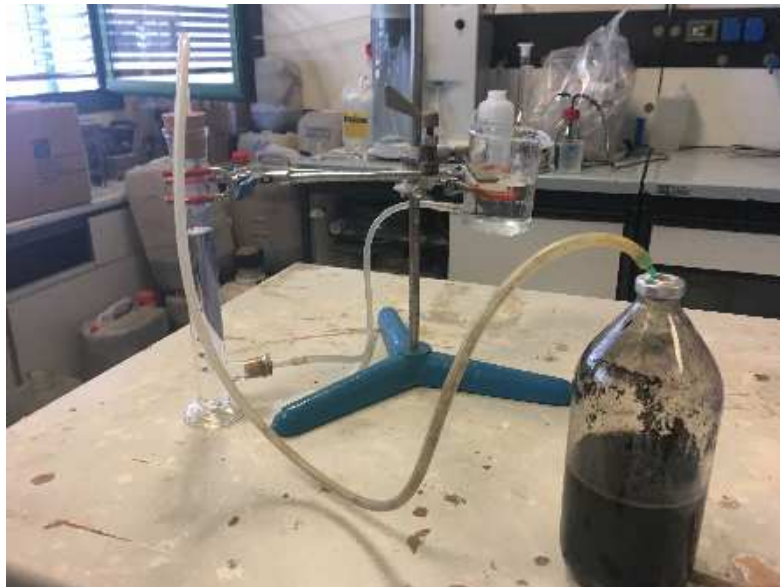
Fig. 6.2: strumentazione utilizzata per la misura giornaliera della produzione di biogas
