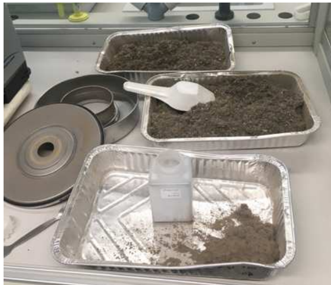
Fig. 6.28: campione trasformato in polvere per le analisi chimiche
