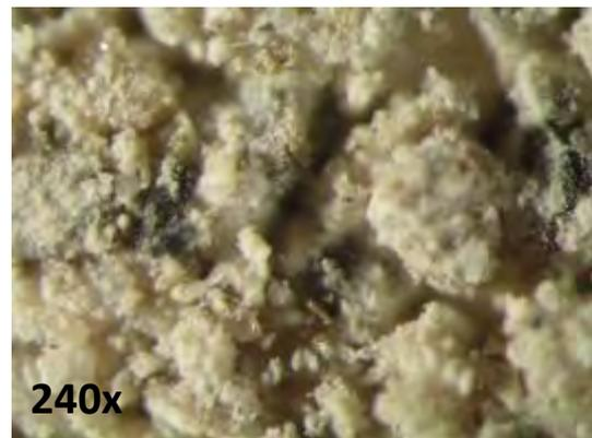
**Osservazioni:** le frazioni legante e aggregato si mostrano di colore chiaro tendente al nocciola. Aspetto comune ai campioni C01 e C02, dove tuttavia la parte degli aggregati si distingue per la presenza di clasti medio-piccoli e omogenei, in parte misti al legante, e di inerti di dimensioni medio-grandi, piuttosto scuri e facilmente distinguibili. La frazione legante B si rivela piuttosto decoesa indicando un basso contenuto di  $\text{CaCO}_3$ .
