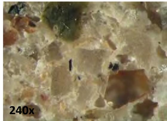
**Descrizione:** Il campione C18 costituisce una malta di giunto ed è formato da un legante di colore variabile dal bianco al giallino, con la presenza di zone più scure tendenti al grigio. L'impasto non è omogeneo e sono visibili microfratture e macropori. La malta è magra e molto decoesa. Per le sue
