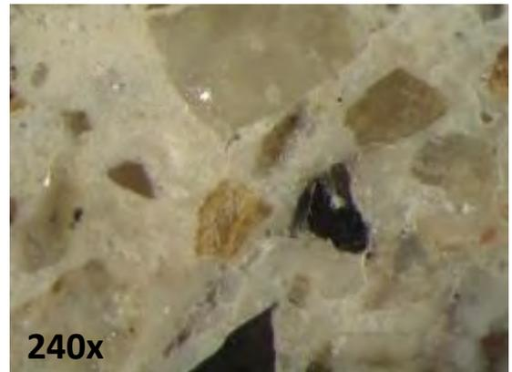
**Descrizione:** Il campione C02 è caratterizzato da una malta magra e di scarsa coesione. Il legante è di color bianco chiaro e dalla struttura abbastanza omogenea. Gli aggregati sono mediamente addensati nella matrice e poco classati. Sono presenti inclusi di dimensioni molto differenti tra loro, di cui alcuni molto grandi. La loro forma è varia, generalmente di media sfericità e fortemente angolosi. Il
