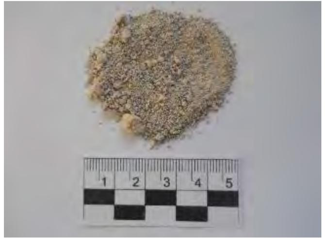
**Descrizione:** Analogamente a C16, la malta è molto decoesa di colore bianco-nocciola e caratterizzata da un aspetto pulverulento. Anche in questo caso potrebbe trattarsi di una malta magra o realizzata con una calce di scarsa qualità non ben carbonatata. Non è stato possibile ottenere una sezione del campione.
