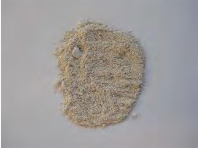
**Descrizione:** Il campione C16 appartiene a una malta di giunto di colore chiaro e priva di coesione. Non è stato possibile ottenere una sezione del campione.
