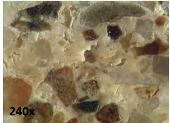
**Osservazioni:** Il campione C11 si caratterizza per una estrema fragilità e la presenza di aggregati di diverse dimensioni con clasti di grande formato dalla forma irregolare. La sezione lucida evidenzia come la malta sia magra con una presenza ridotta di legante e una spiccata microporosità. Il colore è tendente al nocciola-grigio e gli inerti sono perlopiù chiari con inclusi di colore marrone-rossiccio. Sono presenti anche inclusi di colore chiaro.
