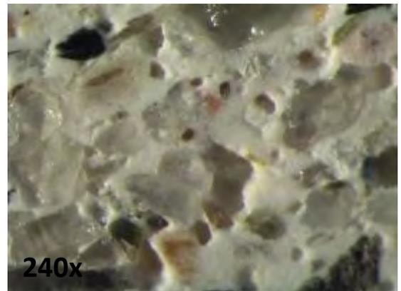
**Descrizione:** Il campione C13, parimenti al C12, proviene da 22 cm al di sotto dell'attuale pavimento della chiesa ed è caratterizzato da un aspetto completamente diverso rispetto alle malte precedenti.
