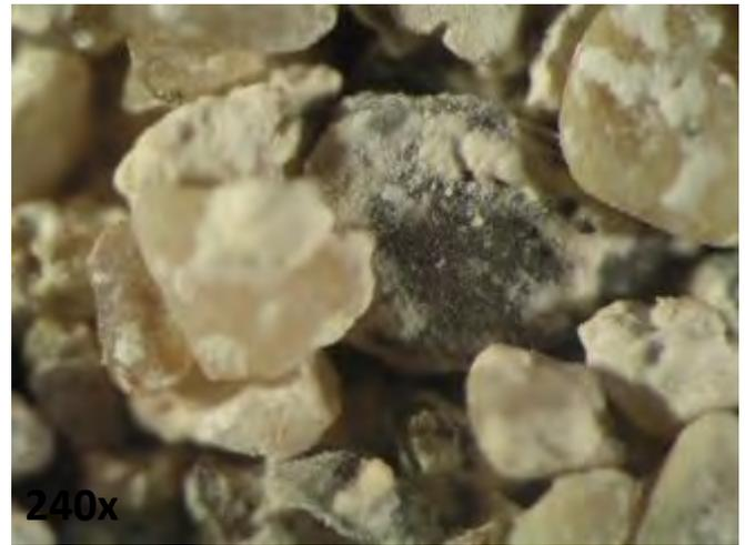
**Osservazioni:** le frazioni legante e aggregato si presentano di colore chiaro tendente al nocciola. La parte degli aggregati si distingue per la presenza di clasti medio-piccoli e omogenei, e di inerti di dimensioni medio-grandi piuttosto scuri. I clasti appaiono ben separati dal legante ad indicare nuovamente una scarsa adesione del legante stesso, che si qualifica come una polvere molto sottile ed omogenea.
