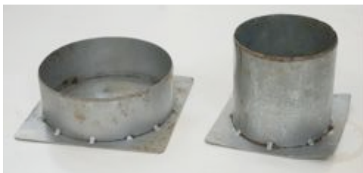
Fig. 13: carotatori a volume noto (280 cc) per orizzonte Oh (a sinistra) e per orizzonte A (a destra) per il rilevamento del QBS-ar.
