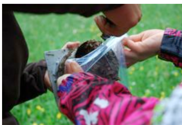
Fig. 14: esempio di prelievo di un campione per la valutazione del QBS-ar mediante carotatore a volume noto e trasferimento in contenitore plastico per il successivo trasporto in laboratorio.
