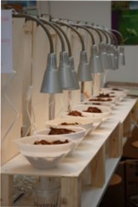
Fig. 16: estrattori di tipo Berlese-Tullgren in batteria utilizzati per l'estrazione dei microartropodi del suolo.
