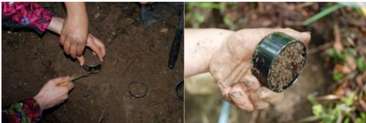
Fig. 12: procedura di campionamento, a mezzo di carotatori cilindrici, di aliquote indisturbate di suolo per l'analisi delle proprietà fisiche del suolo.
