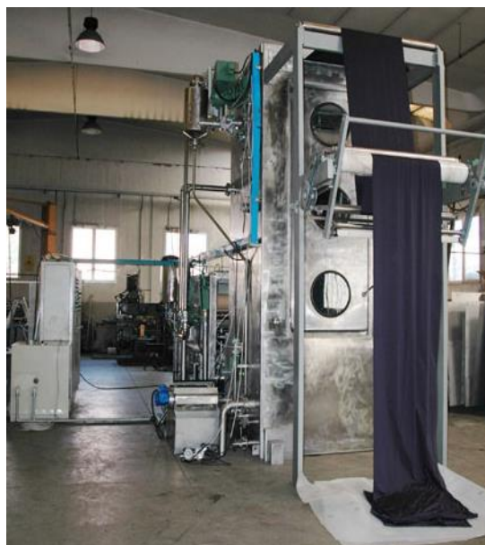
Fig. 25 Sistema completo per la mercerizzazione di filati in matasse e tessuti (ALVE Textile Machinery)
