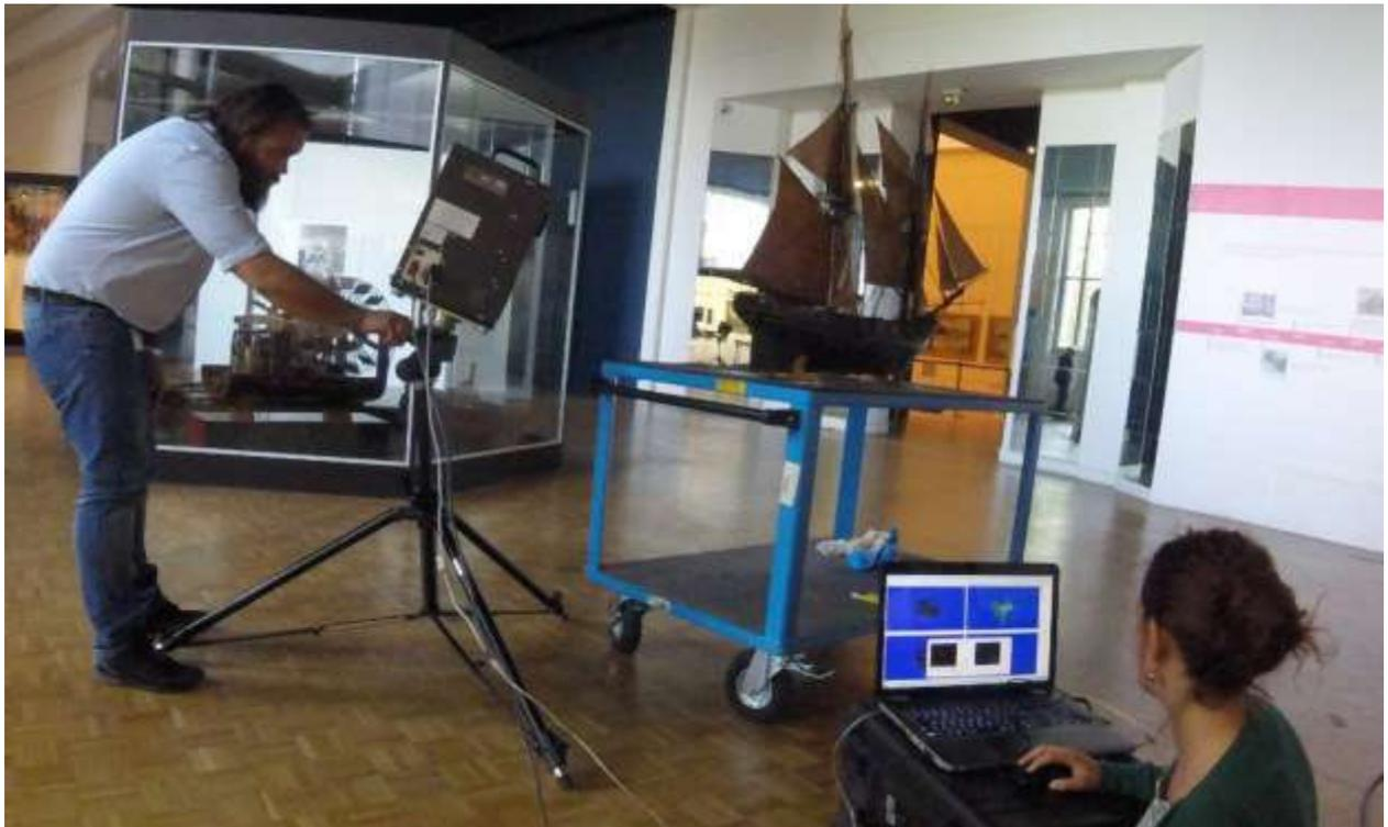
Fig. 2.3-7. Laser Scanner triangolatore Minolta Vivid-9i. Rilievo del modello ligneo del brigantino Cygne.
