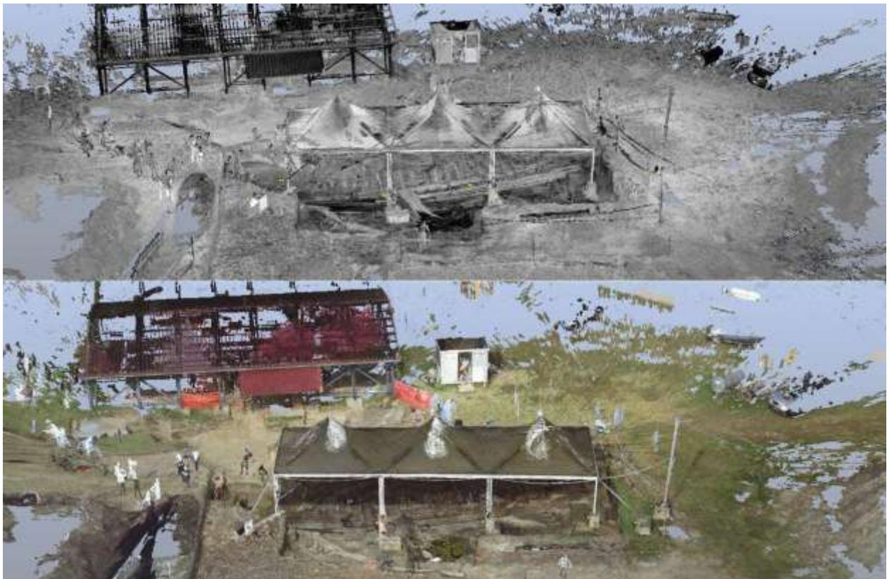
Fig. 2.3-6. Laser Scanner Faro Focus 3D 120. Rilievo barca di Santa Maria in Padovetere a Comacchio, 2015. Confronto tra nuvola di punti *intensity* e nuvola di punti con valori radiometrici.
