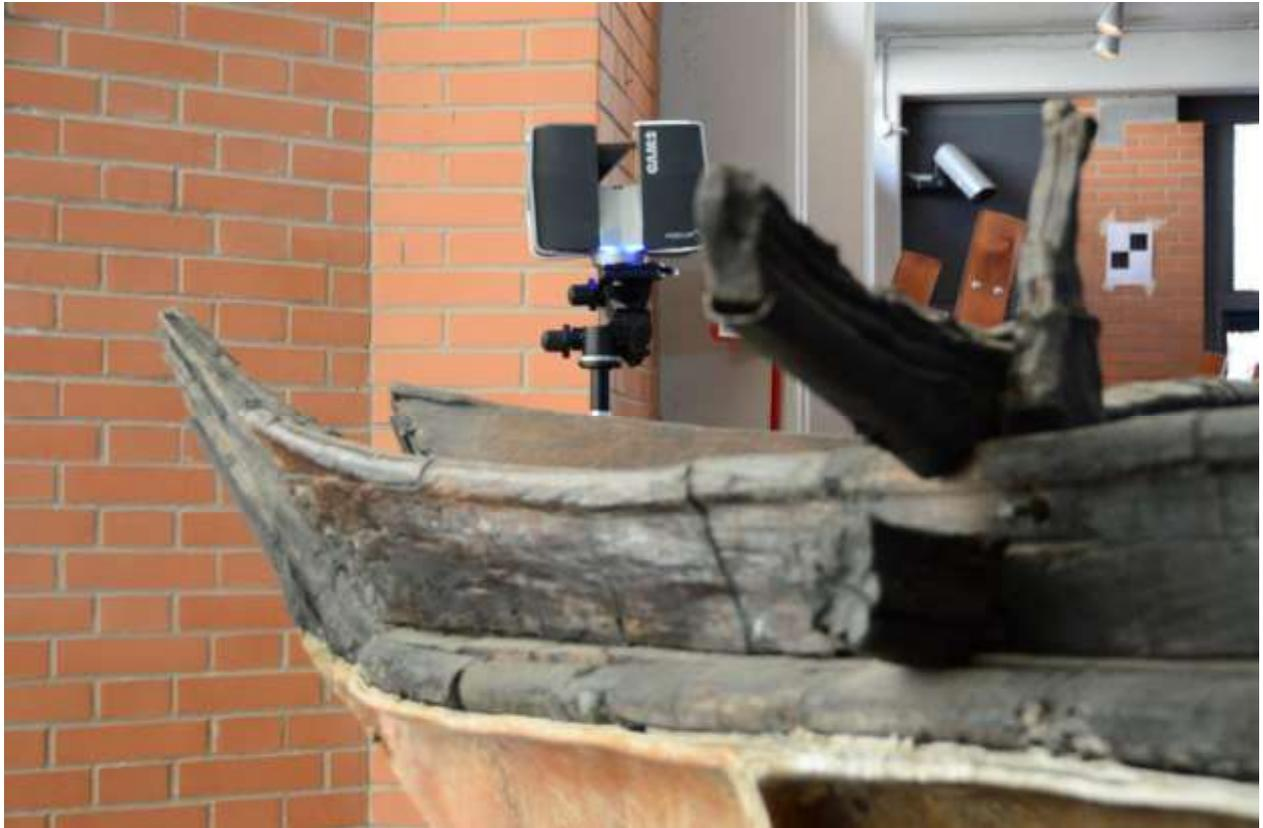
Fig. 3.2- 10. Fase del rilievo laser scanning.
