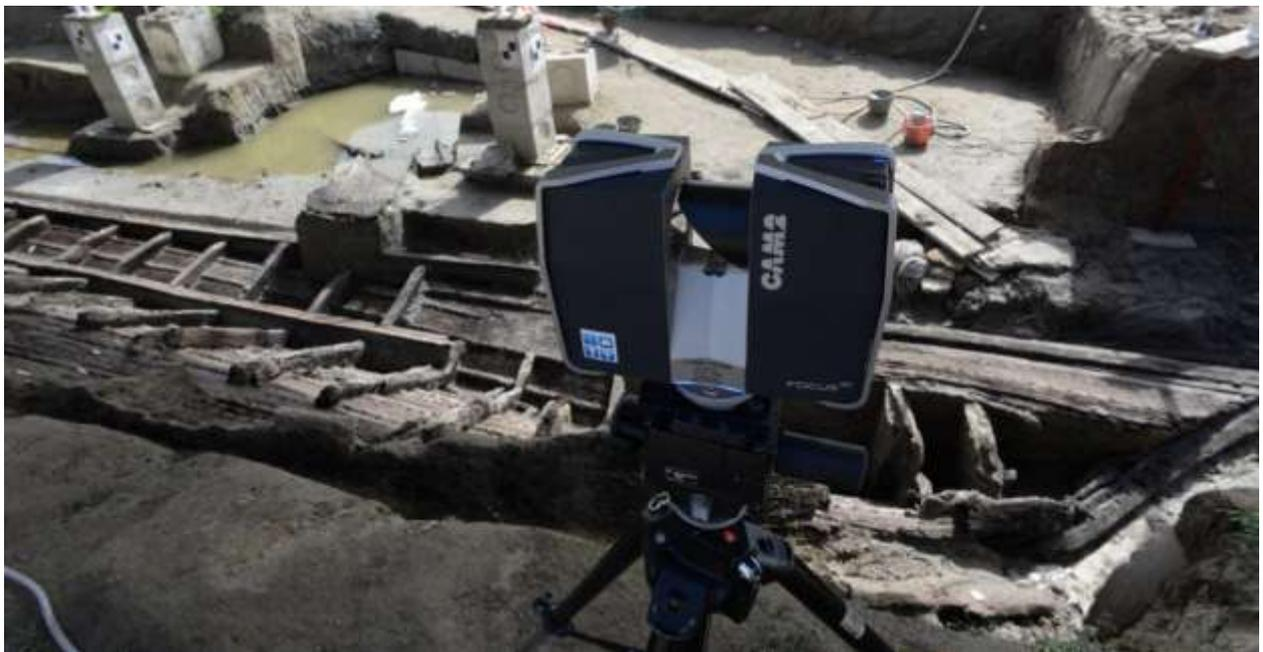
Fig. 2.3-5. Laser Scanner Faro Focus 3D 120. Rilievo barca di Santa Maria in Padovetere a Comacchio, 2015.
