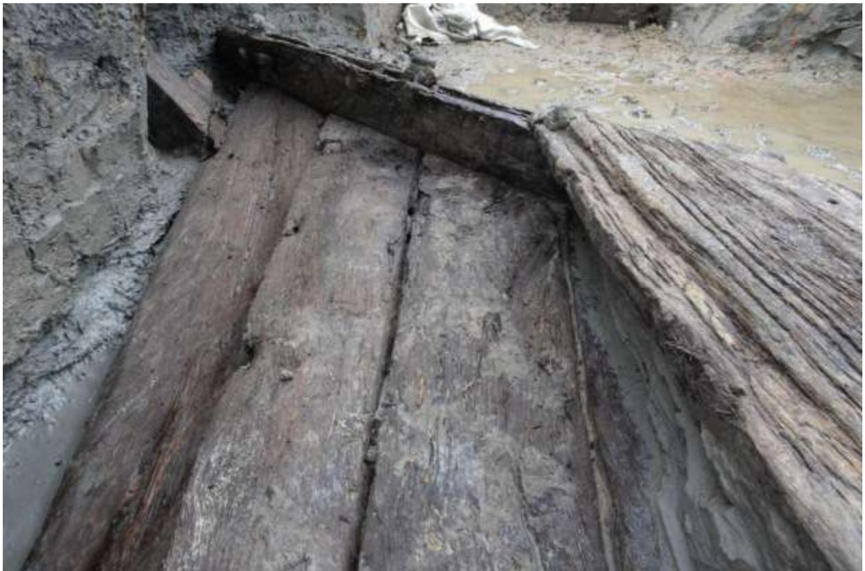
Fig. 3.1-35. Zona di poppa dello scafo in cui si nota sulla destra la calettatura degradante dello spessore della tavola sovrapposta.
