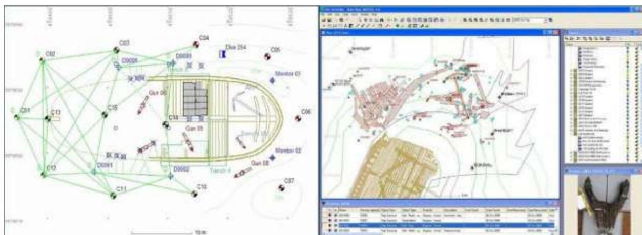
Fig. 2.1-3. Rilievo per trilaterazione attraverso il software *Site Recorder* del relitto del Mary Rose. (da *Site Recorder, User Manual*)
