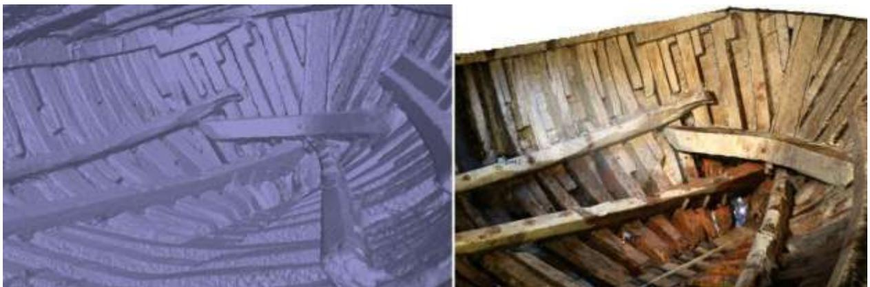
Fig. 2.2-17-18. Trabaccolo Nuovo Trionfo, particolare: *mesh* con colore di default e con valori radiometrici RGB.
