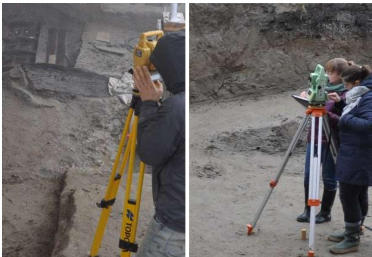
Fig. 2.4-1-2. Stazione Totale Topcon GPT 2005 (Università degli Studi di Milano) e Leica TCR 1103 (Laboratorio di fotogrammetria, Università Iuav di Venezia).
