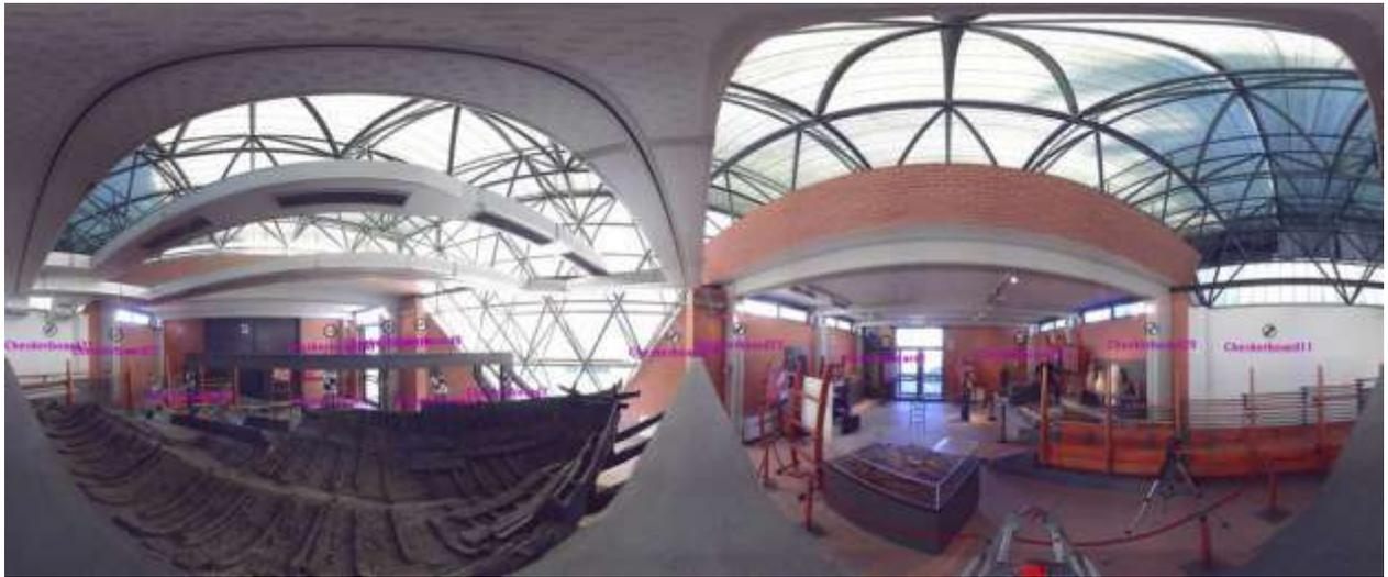
Fig. 3.2- 13. Scansione laser in cui sono evidenti i target utilizzati per l'allineamento delle nuvole di punti.
