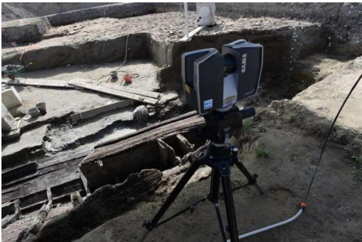
Fig. 3.1-29. Una delle stazioni all'interno dello scavo utilizzate per il rilievo laser scanning. Campagna di rilievo 2015.
