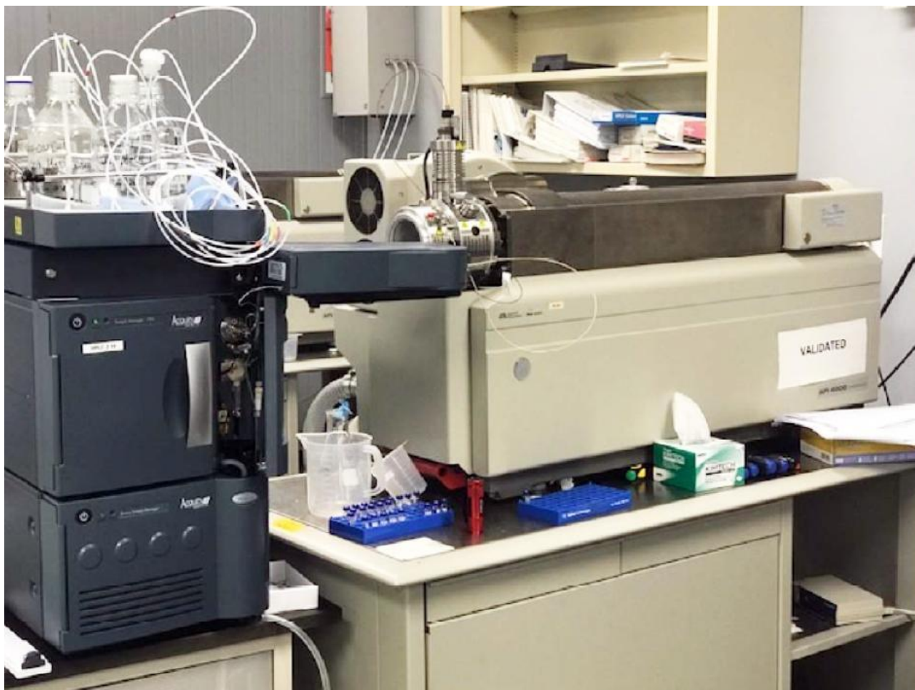
Figura 9 Un cromatografo liquido accoppiato a spettrometro di massa con triplo quadrupolo
