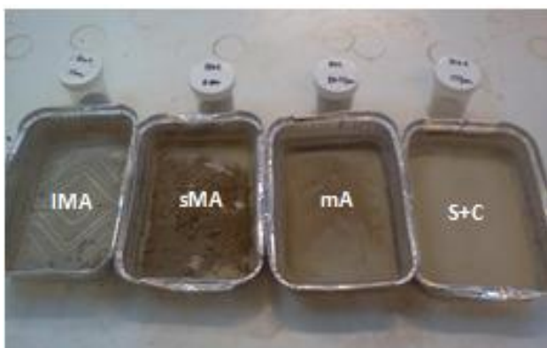
Fig.16- Le quattro frazioni dimensionali di aggregati ottenuti dalla setacciatura ad umido.
