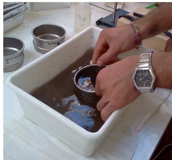
Fig.17 - Setacciatura ad umido attraverso movimenti verticali ascendenti e discendenti per 2 min (25 colpi/min).
