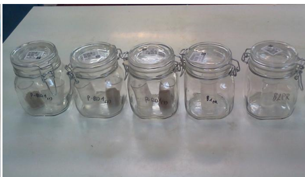
Fig. 20 – Incubazione del suolo e relativi bianchi in fiasche ermetiche chiuse con 4 ml di NaOH.
