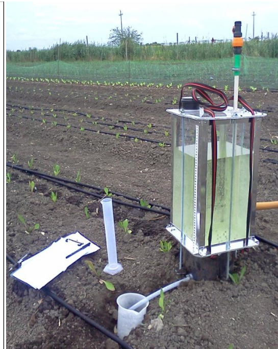
Fig. 14 – Esecuzione del test di infiltrometria effettuato in campo. Si osservi il tubo di scarico per il run-off, il cilindro per misurare l'acqua e il disco rigido inserito a 11 cm di profondità.
