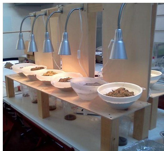
Fig.21 - Apparato di estrazione dei microartropodi di Berlese-Tullgren per la determinazione dell'indice QBS-ar.
