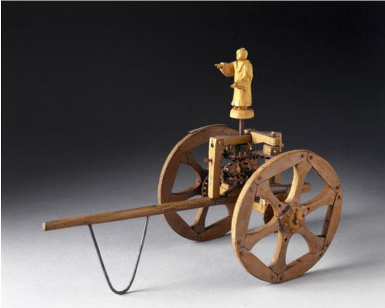
Figura 2. South Pointing Chariot , modello di George H. Lanchester. Museo della Scienza di Londra
