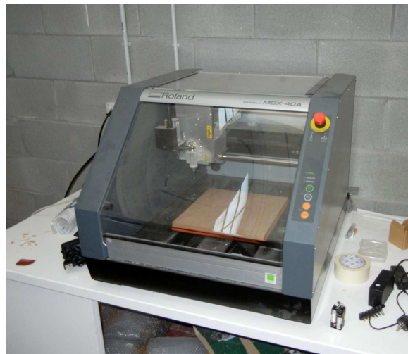
La fresa CNC a quattro assi Roland MDX- 40A, con area di lavoro 30x30x10 cm
