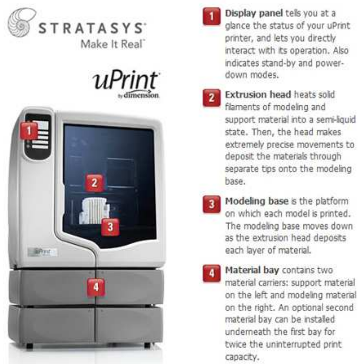
Immagine 2: Stampante 3D Stratasys con descrizione dei componenti, Fonte: http://www.ces-show.com/news_images/00462_3d-printer.jpg
