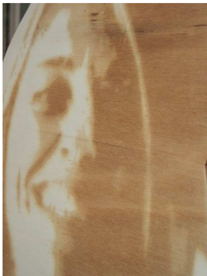
Un esempio di lavorazione laser a partire da una semplice immagine in formato .jpg; il laser può essere modulato per ricreare o incidere la stessa fotografia su materiali come il legno, fedelmente, velocemente e ad alta precisione
