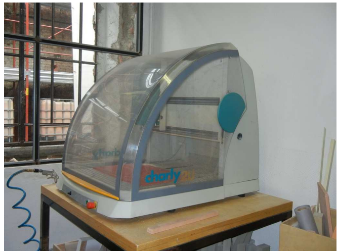
Piccola fresa CNC per piccole lavorazioni e destinata all'apprendimento per il Fab Lab; L'OneOff è dotata anche di una fresa professionale di grandi dimensioni
