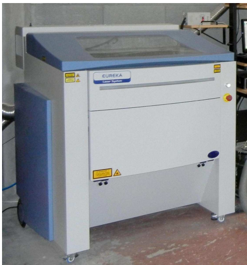
Il laser cutter con area di lavoro 70x50 cm
