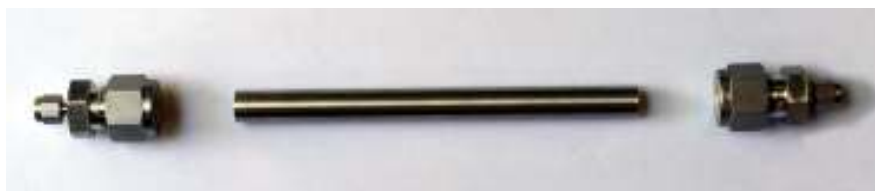
Figura 4.1 – Il reattore (diametro interno 1/4", riduttori ad 1/16")
