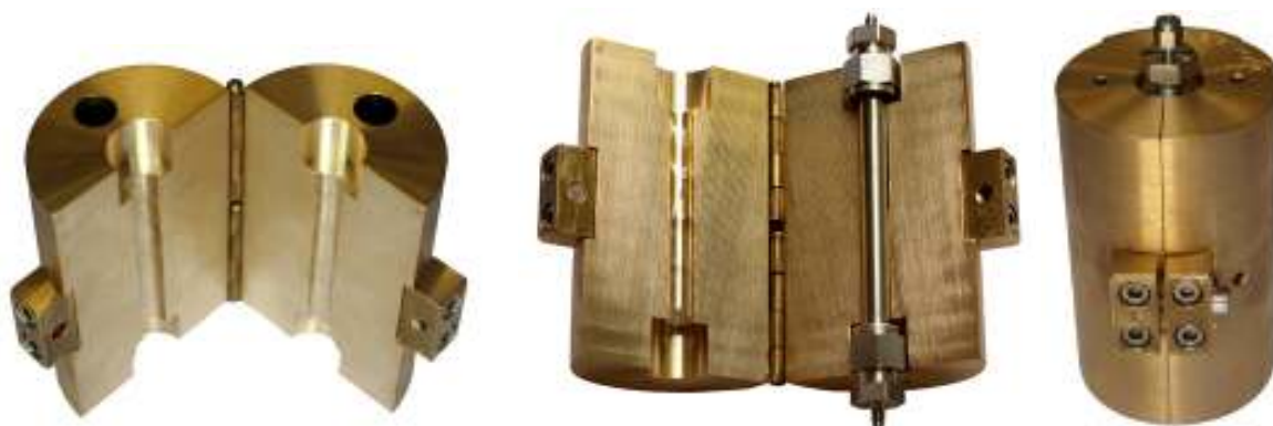
Figura 4.2 – Blocco per il riscaldamento del reattore. A sinistra: nella parte superiore sono visibili i fori per alloggiare le cartucce riscaldanti; al centro: il reattore tubolare è posizionato nel blocco di ottone; a destra: il reattore chiuso nel blocco di ottone. In prossimità della cerniera, è visibile il foro di alloggiamento della termocoppia.
