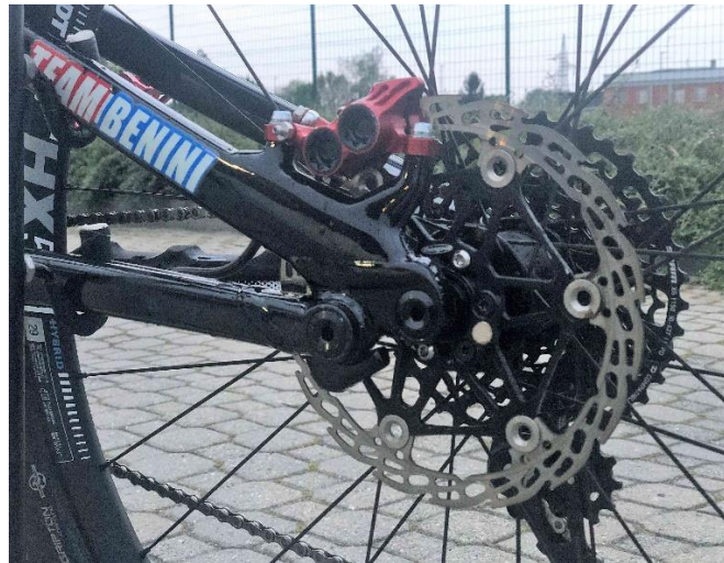
Figura 3.8 Esempio di freno a disco ( ebikefind.com )
