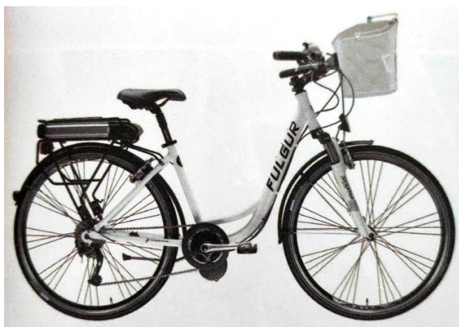
Figura 3.1 Esempio di e-city o pedelec (Volpato 2015: 13)
