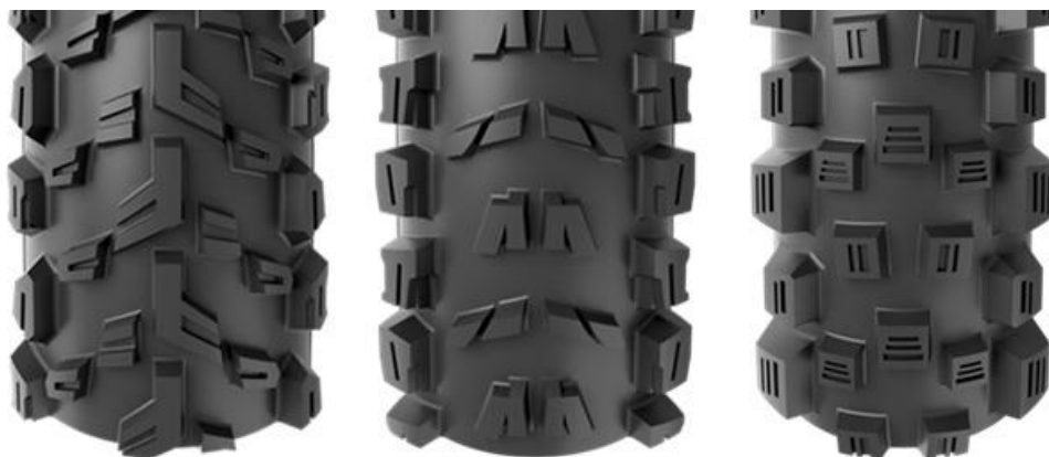
Figura 3.2 Principali tipologie di tasselli per i copertoni MTB, da sinistra verso destra: terreni asciutti, misti e fangosi ( cycletyres.it )
