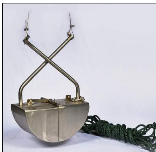
Figura 6.3 Benna di Van Veen utilizzata per il campionamento dei sedimenti.
