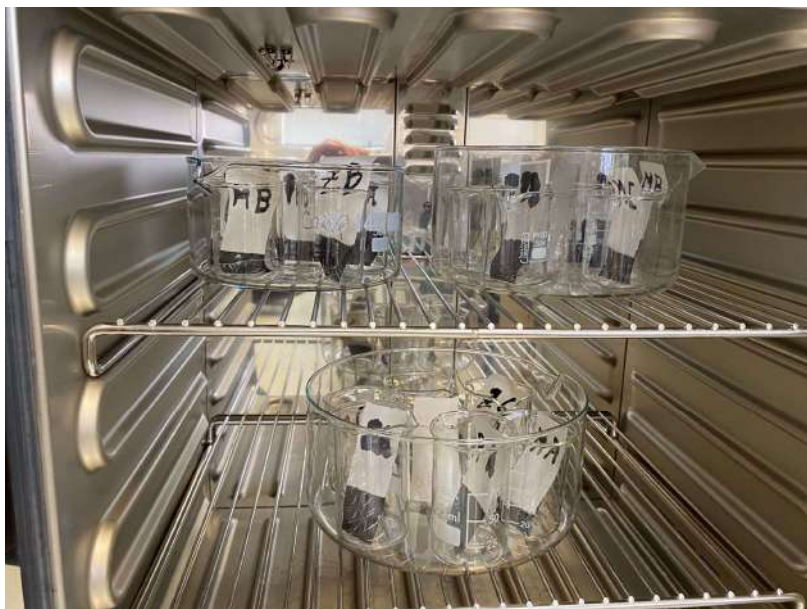
Figura 16 campioni in stufa ad 80°C
