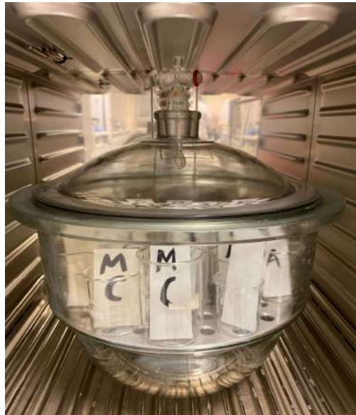
Figura 17 essiccatore con i campioni nella stufa ad 80°C con umidità relativa del 100%
