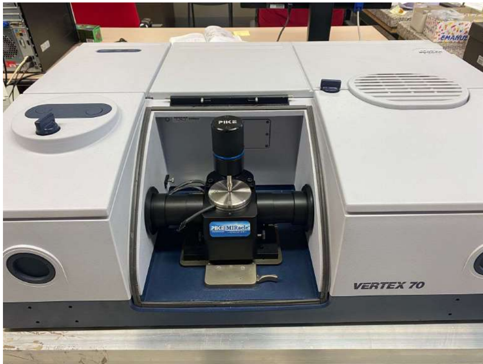
Figura 12 interferometro Vertex 70 della Bruker Optik su cui viene montata l'interfaccia (accessorio ATR).
