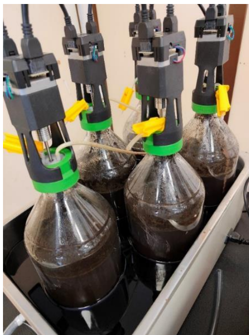
Figura 33: Reattori batch pronti per la prova
