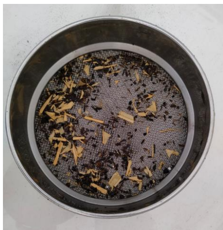
Figura 41: Shopper derivanti da amido trattenute nel setaccio a 2 mm
