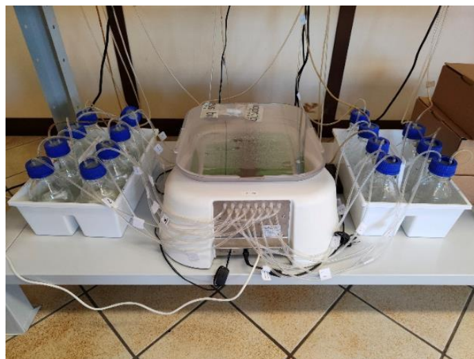
Figura 30: Sistema di misurazione del biogas prodotto
