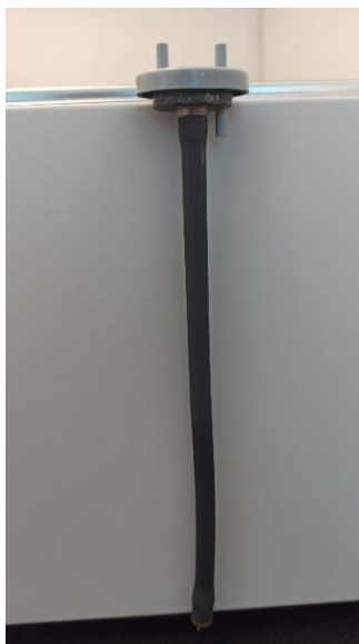
Figura 32: Tappo di chiusura reattori con braccio meccanico incorporato
