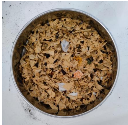
Figura 40: Shopper derivanti da amido trattenute nel setaccio a 5 mm
