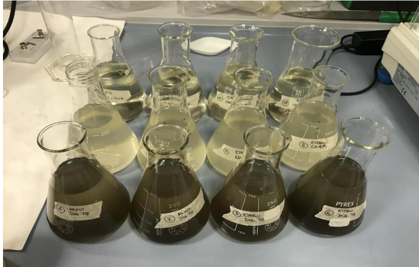
Figura 11: Condizioni sperimentali con digestato da FORSU diluito 1:10 senza pretrattamenti (noPT), dopo centrifugazione (AC), dopo filtrazione a 0.45 \mu\text{m} (AUF).
