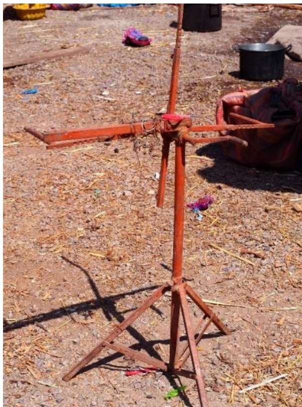
Figure 5- Strumento meccanico per creare la matassa (arcolaio)
