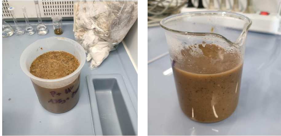
Figura 22 e 23: Miscela non cavitata (sinistra) e cavitata (destra)
