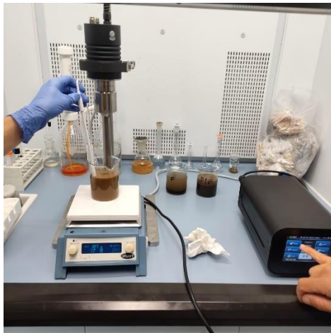
Figure 13 e 14: Sonicatore utilizzato (a sinistra) e schema delle componenti dello strumento (a destra) (fonte: https://www.alkemikosvapo.com/2018/07/05/lestrazione-ultrasuono-assistita/# )
