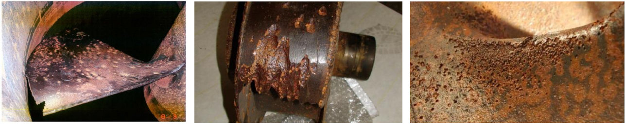
Figure 9, 10 e 11: Turbina (a sinistra), girante di una pompa (al centro) danneggiati dalla cavitazione e superficie della pompa (a destra) (fonti: Krella, 2023, https://modernpumpingtoday.com/erosion-corrosion-and-cavitation-oh-my/ e Thamsen et al., 2008)
