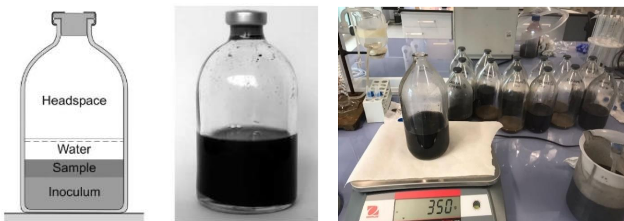
Figure 18 e 19: Bottiglia per il test di biodegradabilità anaerobica BMP (a sinistra) (Pilli et al., 2011) e preparazione delle repliche (a destra)
