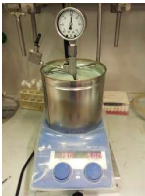
Figura 3.4. L'autoclave utilizzata per la cicloaddizione di CO 2 a SO a differenti pressioni
