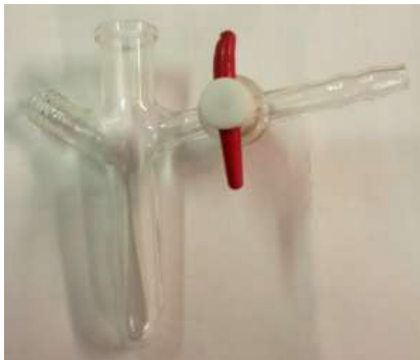
Figura 5.1 - Il reattorino impiegato nelle reazioni
