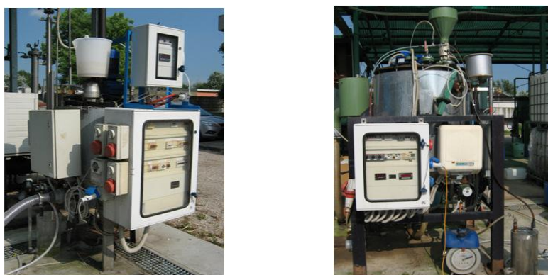
Figura 19: reattori impiegati per la produzione di bio-hythane: dark fermentation (sinistra) e metanogenesi (destra)
