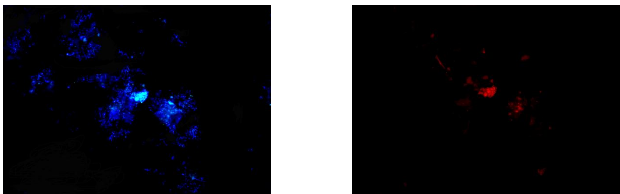
Figura 59: Analisi molecolare FISH effettuata nel reattore della dark fermentation: biomassa microbica completa (sinistra); Methanosarcina (destra).
