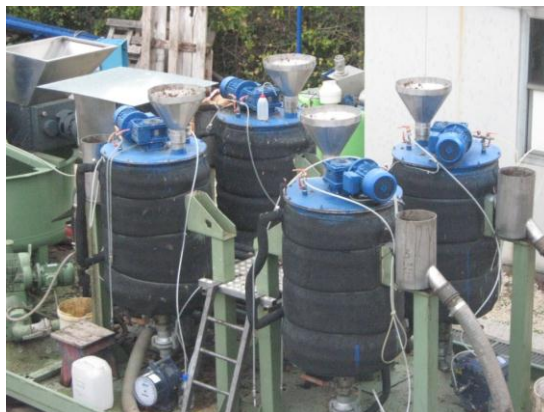
Figura 22: Reattori impiegati per il trattamento di matrici agroindustriali
