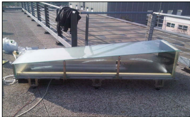
Copertura in vetro extrachiaro da 7 mm (3+3mm di vetro e 1 mm di policarbonato)
