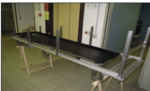
Struttura di sostegno della serra solare in acciaio 316L.
