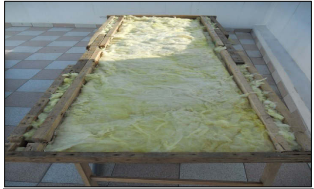
Strato di isolamento termico (lana di vetro da 4 cm con K=0.04 \text{ W/m K} )
