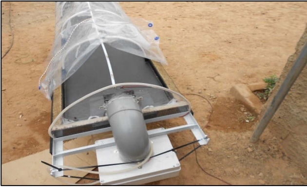
Copertura in ETFE da 0.3 mm
