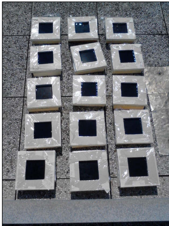
Figura 11 – Comparazione in parallelo del grado di evaporazione idrica con diversi materiali e colorazioni
