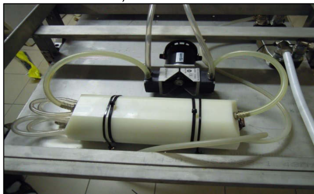
Scambiatore di calore a pacco alettato e pompa di ricircolo
