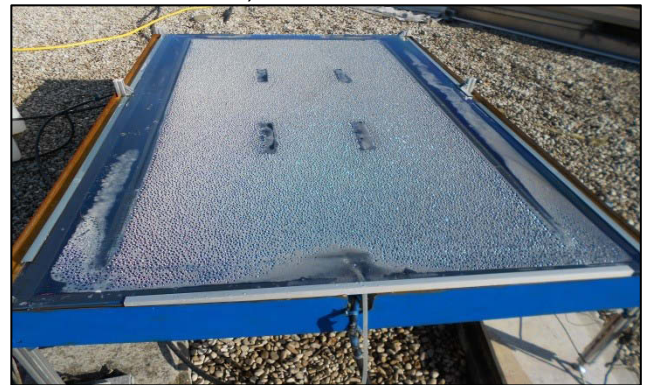
Copertura in policarbonato da 0.3 mm
