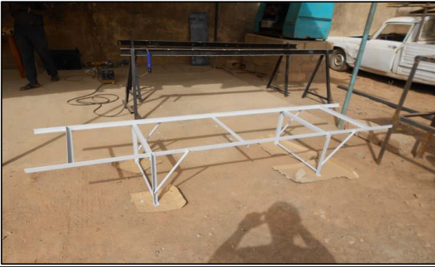
Struttura di sostegno della serra solare in acciaio
