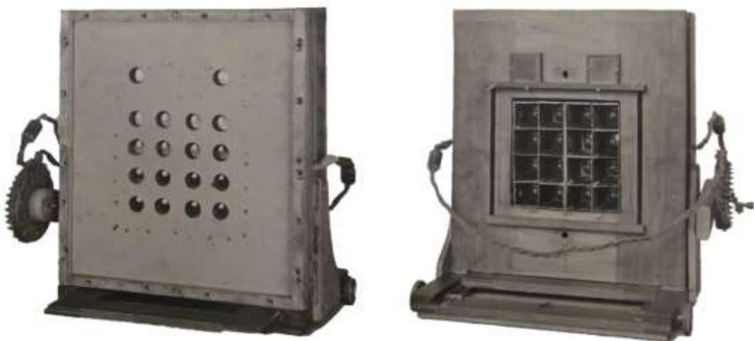
*Figura 23 – La macchina da presa a sedici lenti con gli otturatori rimossi (a sinistra) e il lato posteriore dello stesso apparato con le sedici camere d'esposizione in evidenza (a destra)
