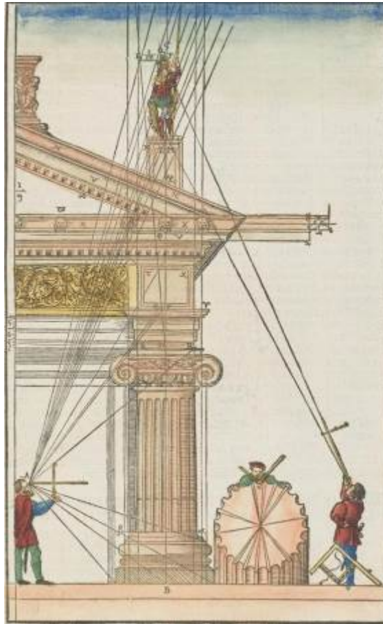
Fig. 35. Balestriglia, la determinazione di un'altezza di un oggetto 2453 .
