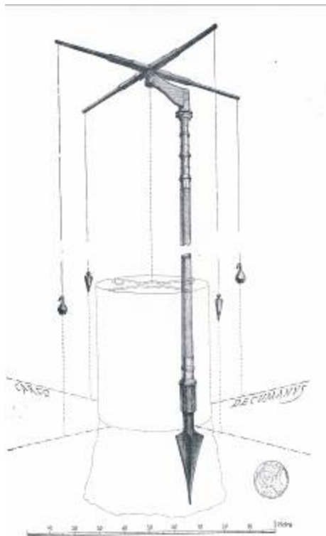
Fig. 32. Ricostruzione della groma da Matteo della Corte 2450 .
