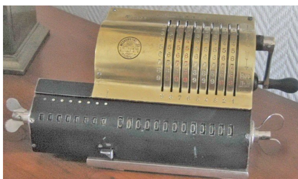
Fig. 5: Un aritmometro costruito da W. T. Odhner a San Pietroburgo prima del 1900. Fonte: http://dic.academic.ru/pictures/wiki/files/79/Odhner_made_before_1900.jpg .
