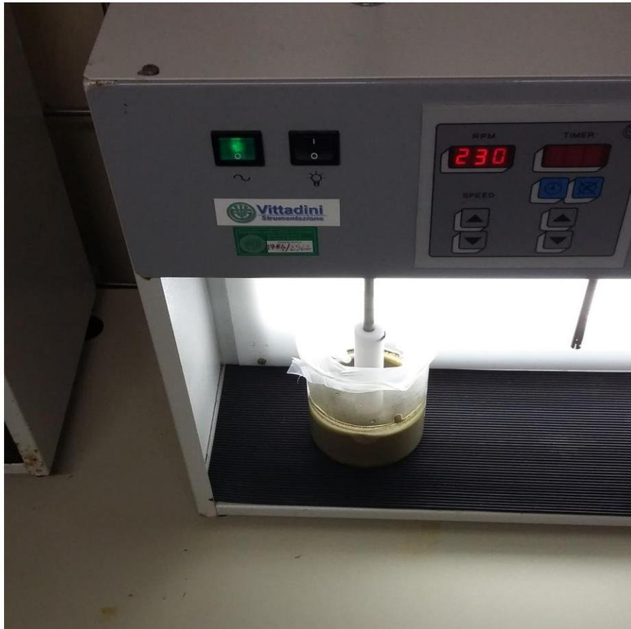
**Figura 8 - Campioni in agitazione nello Jar test nella camera climatica a 4 °C**
