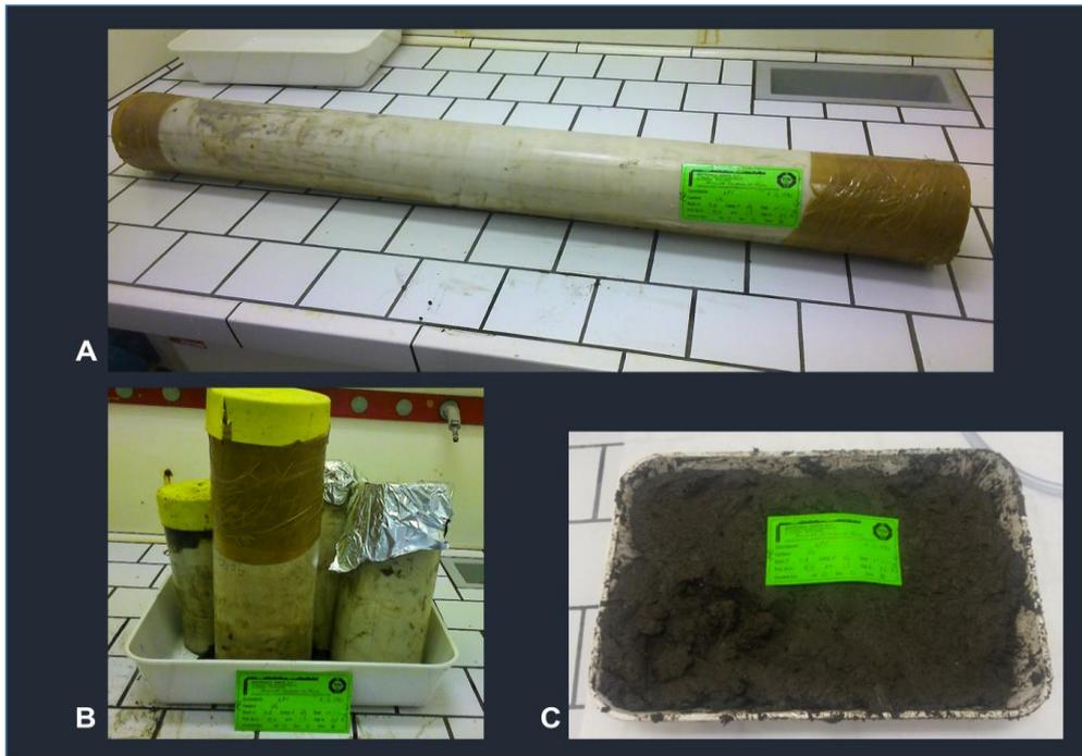
**Figura 7 – A) carota di sedimento “tal quale”; B) carota divisa in sezioni; C) sedimento omogeneizzato**
