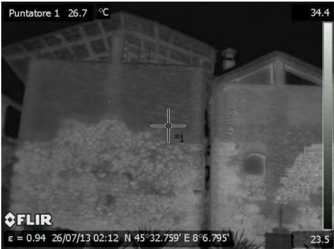
Fig. 99: Candelo, Ricetto, esempio di immagine IR di un prospetto (Foto CNR-IBAM).
