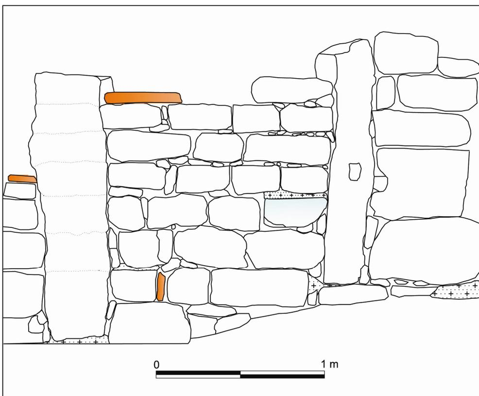
Fig. 19. Tecnica 1, muro ES 4 (stenopos 19, Casa dei capitelli ionici).
